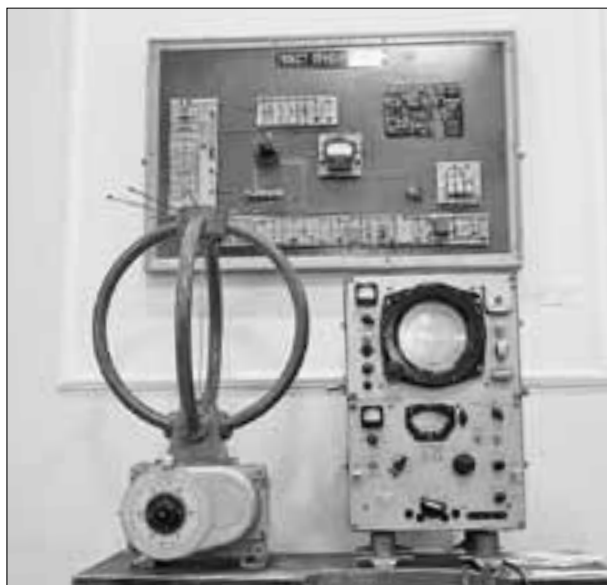
■ Аппаратура пеленгатора улавливала длинные и средние радиоволны. Она размещалась в кузове автомобиля ГАЗ-69. ФОТО: ИВАН МАЛЫГИН
