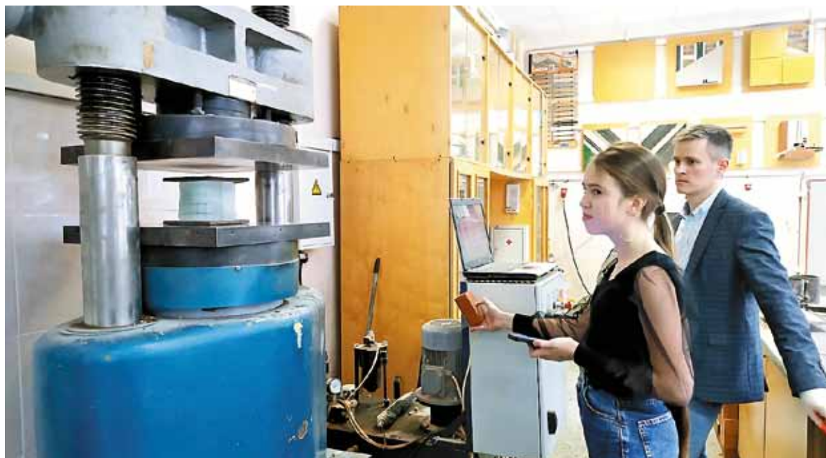
➤ Перед тем как поместить лед между металлическими плитами пресса, нужно положить кусочки войлока, для того чтобы лед не таял
