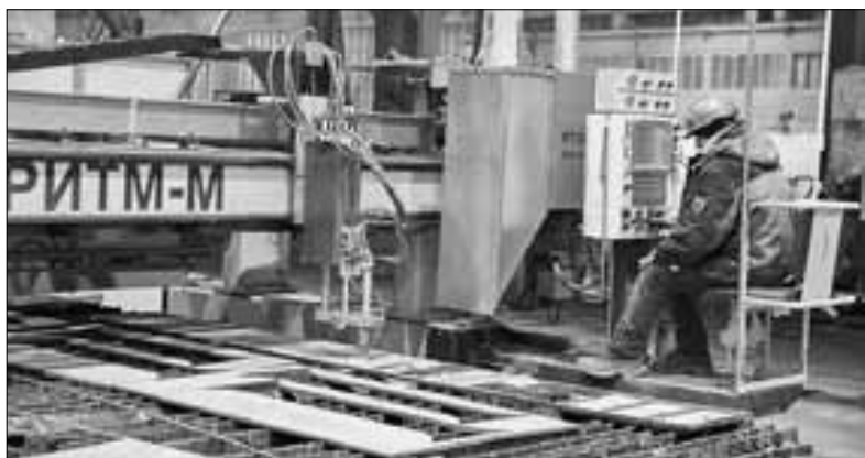
■ Машина РИТМ-М предназначена для термической резки заготовок в судостроении и судоремонте
